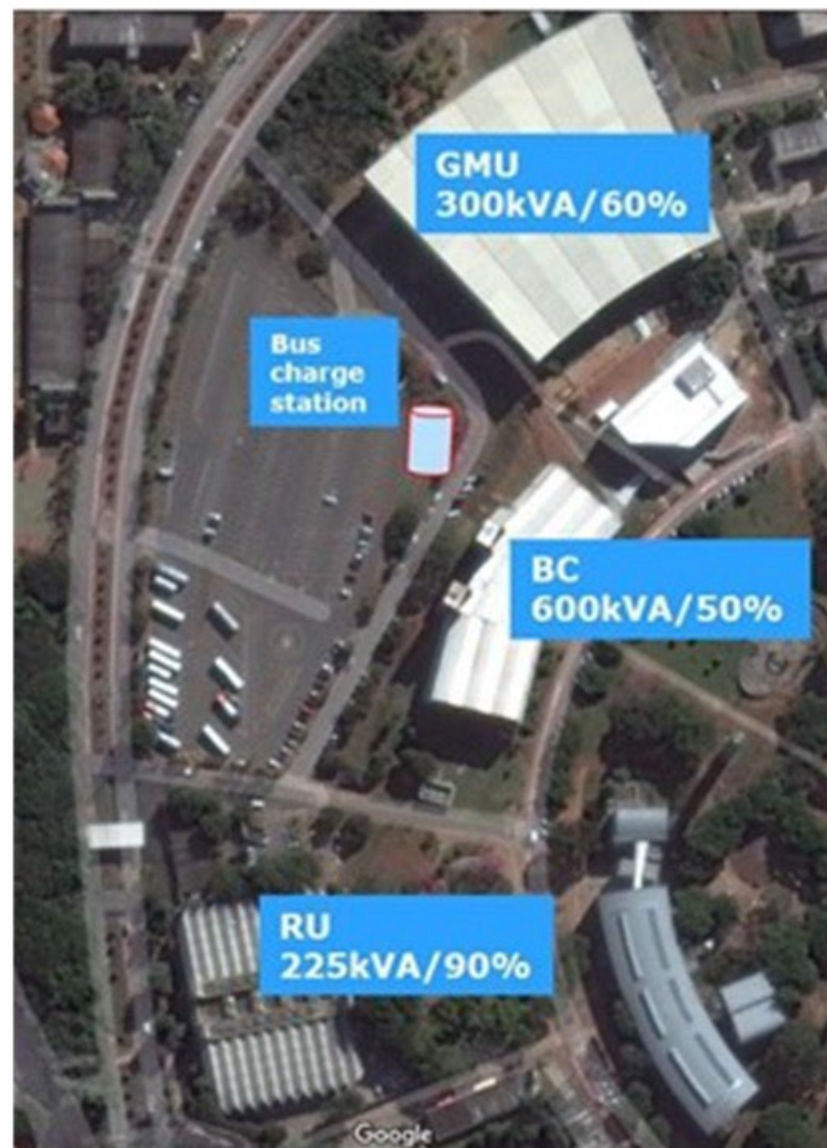
Microrrede Campusgrid - implantação em parte do Campus Universitário Unicamp/Campinas
