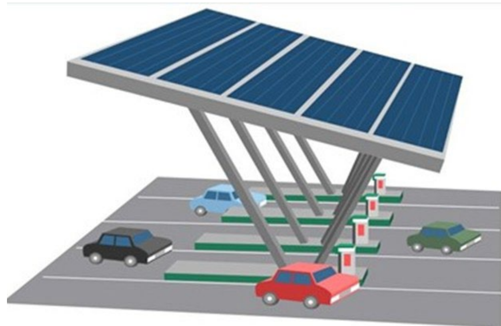
Microrrede Nanogrid - para diferentes tipos de veículos elétricos, estações de carregamento e geração solar (Baixa Tensão)
